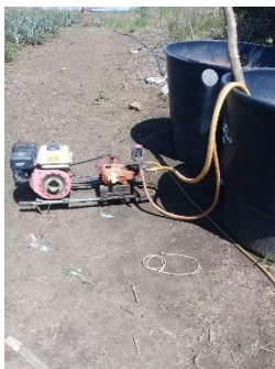
conexión de moto-bomba estacionaria para aplicación de insumos
