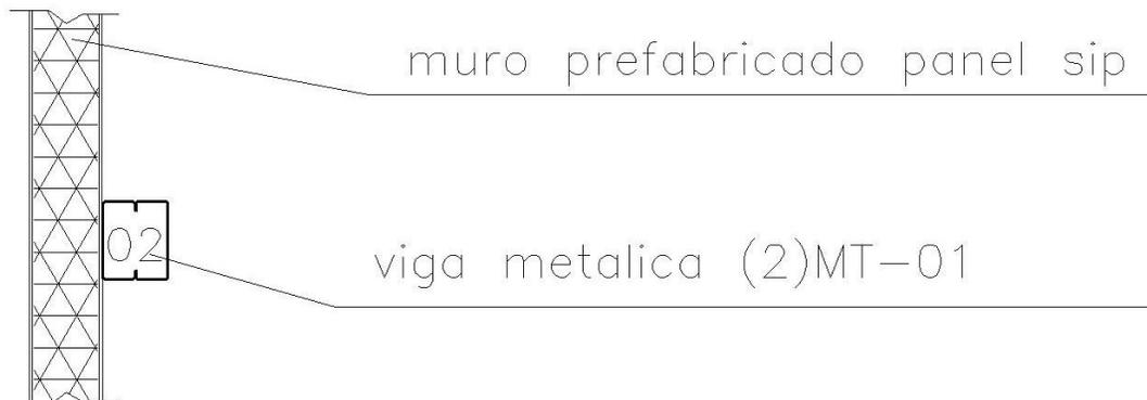
DETALLE 02 ANCLA MURO A ESTRUCTURA METALICA
